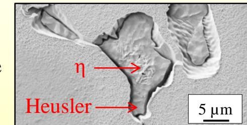
$\eta$ -phase  $\text{Ni}_3\text{Ti}$
